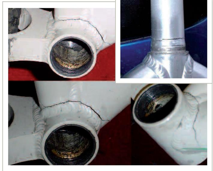
Fissure importante au niveau de la boîte de pédalier juste au-dessus de la soudure
