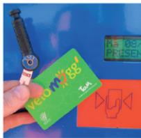
vélo distribuée automatiquement par un totem installé dans la rue. Cette clé permet d'ouvrir le cadenas d'un vélo sécurisé à côté du totem. Le vélo est repéré par un numéro indiqué sur la clé. Ces clés contiennent une petite puce électronique qui permet d'assurer la traçabilité des usages. Simple, robuste et efficace!
