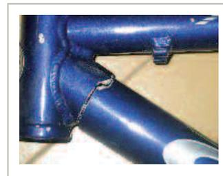
Fissure, puis rupture d'un tube diagonal de cadre
