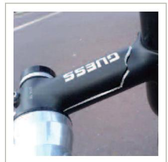
Fissure puis rupture d'une potence
